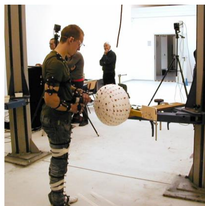
Rys. 3. Tworzenie i walidacja empiryczna EMA: doświadczalne ustawienie w celu skanowania ruchu przy złożonej operacji z wkrętarką akumulatorową (chwyt rewolwerowy) [7]
